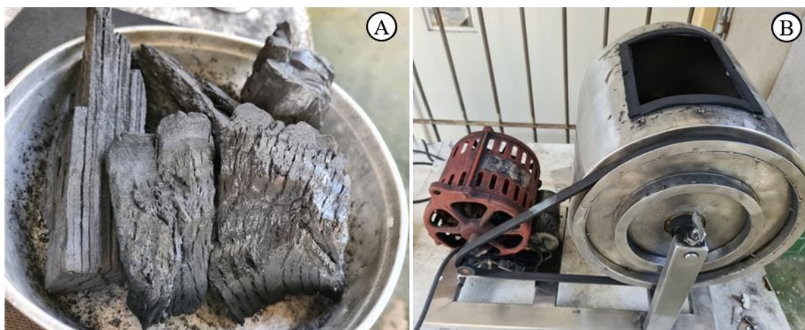
Figura 12 - Amostras de carvão utilizadas (A) e tambor rotatório elétrico utilizado no teste (B).
