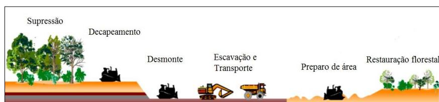
Figura 2. Processo de mineração de bauxita e restauração de áreas degradadas. Fonte: Martins, 2016.
