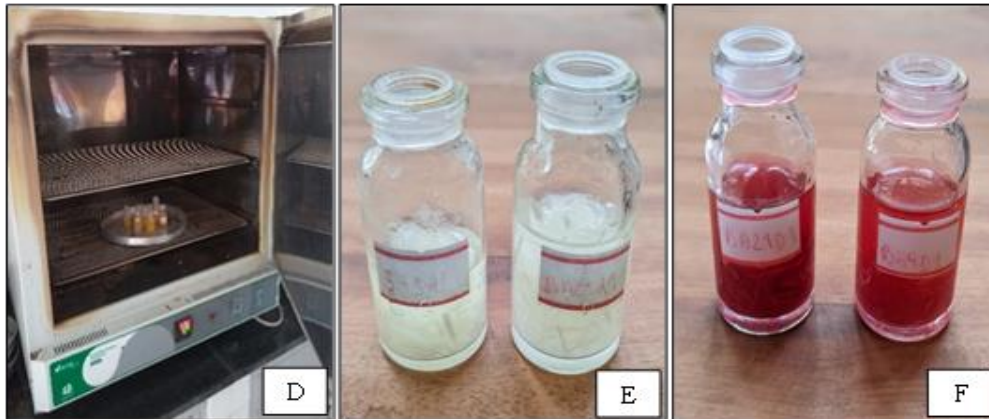
Figura 8. Etapas do processo de maceração da madeira. a) Cavacos de madeira da espécie T. vulgaris . b) diminuição de tamanho do material. c) amostras com a solução macerante. d) Material na estufa por 24 horas. e) amostras após o processo de dissociação dos elementos. f) material corado com Safranina. Fonte: Autor.
