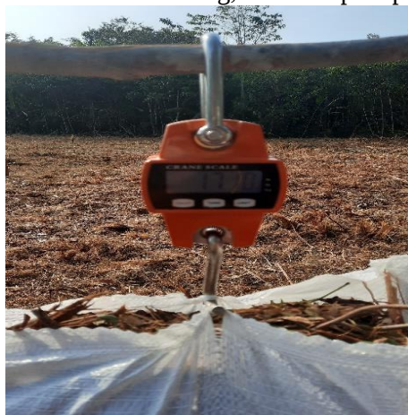
Figura 9. Balança Suspensa Crane Skale 50 Kg, utilizada para pesar a biomassa em campo.
