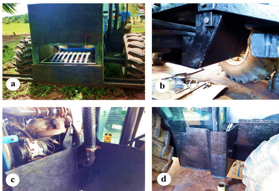
Figura 5. Adaptações feitas no trator TL 95 para proteção das peças e maior durabilidade do trator: a) Parte frontal; b) peito do motor; c) Abaixo do trator d) lateral do motor.
