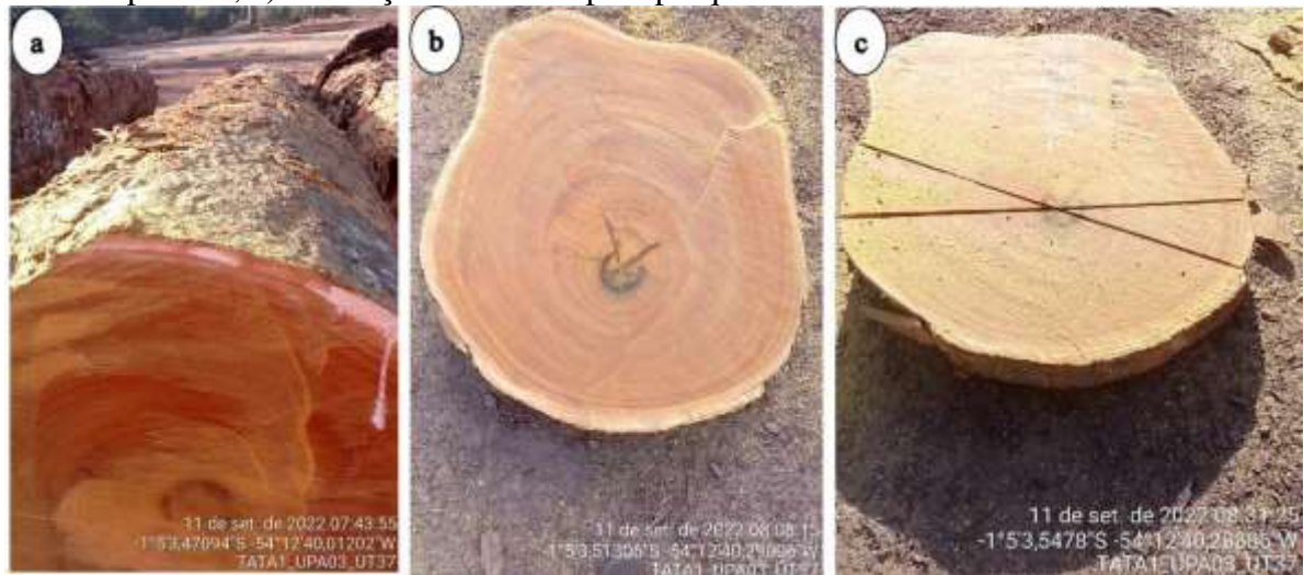
Figura 4 - Coleta de amostras: a) Fuste no pátio de estocagem; b) Disco de madeira com 10 cm de espessura; c) confecção de cunhas para pesquisa.
