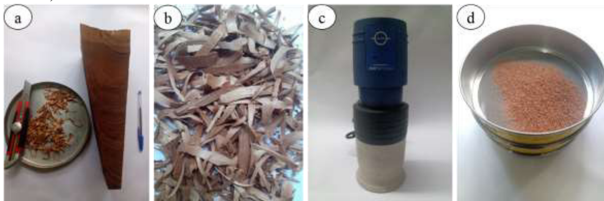
Figura 9 - Procedimento para determinar o teor de carbono: a) Retiradas de lascas de madeira com estilete; b) Lascas de madeiras; c) Moinho analítico básico IKA11 de três facas d) Peneiras de 40 e 60 mesh.
